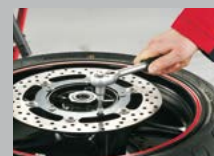
3. Wykręć śruby mocujące tarczę hamulcową.
