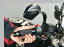
6. Sprawdź punkt docisku hamulca oraz swobodę poruszania się koła. Oczyść tarcze.
