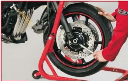
1. Unieruchom motocykl i zdemontuj zacisk hamulcowy
