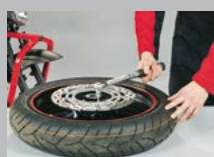
5. Zamontuj nową tarczę i dokręć śruby mocujące.
