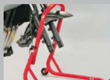
2. Odkręć nakrętki na osi i zdejmij koło.
