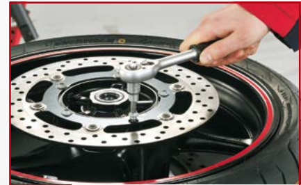
3. Wykręć śruby mocujące tarczę hamulcową
