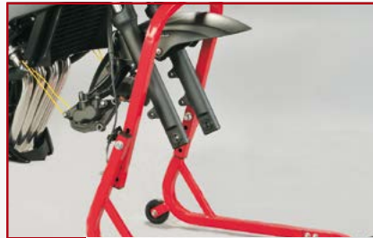
2. Odkręć nakrętki na osi i zdejmij koło
