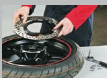
4. Zdejmij zużyłą tarczę i oczyść powierzchnię styku piasty z tarczą.
