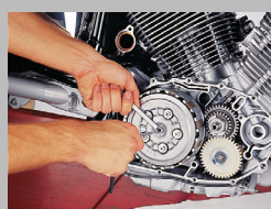
6. Registrare il gioco della frizione e del meccanismo di rinvio, la procedura può variare secondo il modello.
