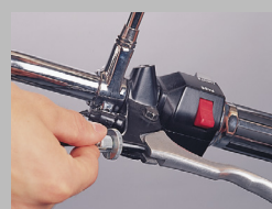
8. Registrare il cavo della frizione con 4 mm di gioco.
