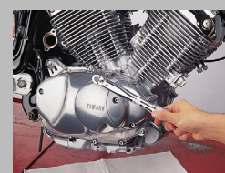
7. Rimontare il carter della frizione con una guarnizione nuova, prestare attenzione alle boccole di centraggio e stringere le viti gradualmente in ordine.
