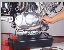
1. Preparare gli attrezzi necessari, proteggere il pavimento e scaricare l'olio.
