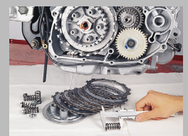
4. Verificare: lo stato di usura dei componenti, le molle di pressione, i dischi in acciaio e la campana della frizione. Sostituire se necessario.
